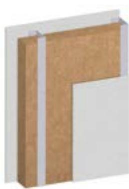
Leichte Holzständertrennwand mit GUTEX Thermofibre®/ GUTEX Thermoflex®/ GUTEX Thermosafe-homogen®
