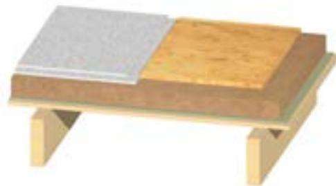
*GUTEX Thermosafe-wd<sup>®</sup> auf offener Balkenlage*
