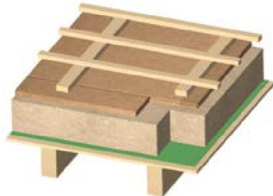
Aufbau einer GUTEX Aufdachdämmung mit GUTEX Thermosafe-homogen® und GUTEX Multiplex-top®
